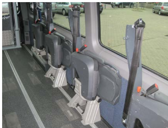
Binnenzijde van een liftbus met opklapbare zetels.
