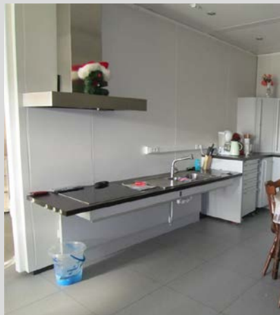
In hoogte verstelbare keuken, cassettevloer en -plafond Studiowonen Inham, ©Enter vzw
