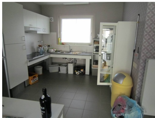
In hoogte verstelbare, aangepaste keuken voor een persoon met een beperking. Dominike Savio Instituut, Molenreke, © Enter vzw
