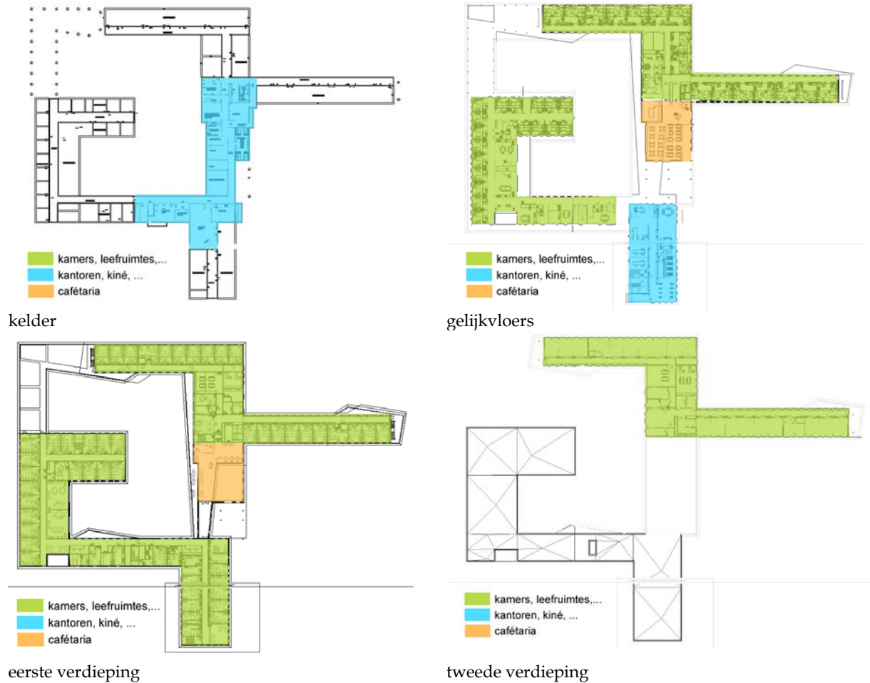
Figuur 13: opdeling in verschillende ventilatiezones (groen: kamers, blauw: kantoren, kiné ..., oranje: cafetaria).
