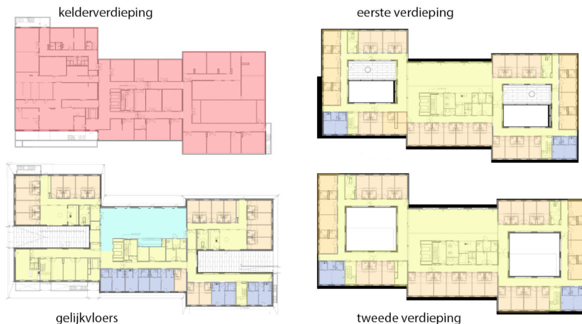
Figuur 1: opdeling in verschillende ventilatiezones (ventilatiezone 1: kamer (oranje), gangen, ondersteunende functies en leefruimte (geel) – ventilatiezone 2: kelder (rood) – ventilatiezone 3 polyvalente ruimte (cyan). Serviceflats (paars)).
