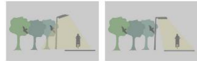
Figuur 2: Links: Onaangepast armatuur dat te veel zijwaartse lichtverstrooiing geeft. Rechts: aangepast armatuur dat gericht enkel het fietspad verlicht. Overgenomen uit Volgt et al. (2018a).
