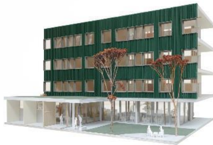
niet-dragende gevel in houten cassette- elementen
