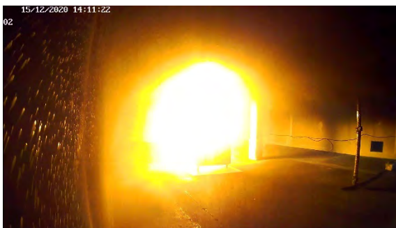
Na 3'22" (activatie 1 e sprinkler)
