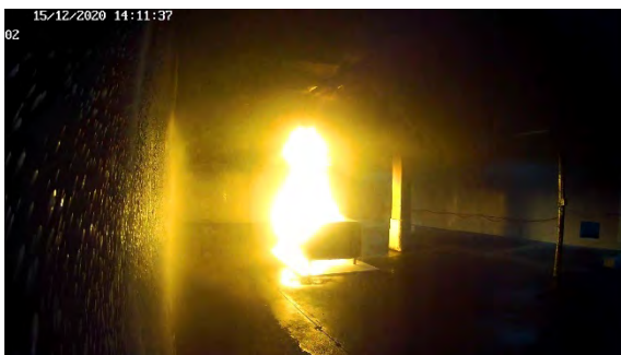
Na 3'37" (activatie 3 e sprinkler)
