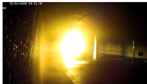
Na 3'31" (activatie 2 e sprinkler)
