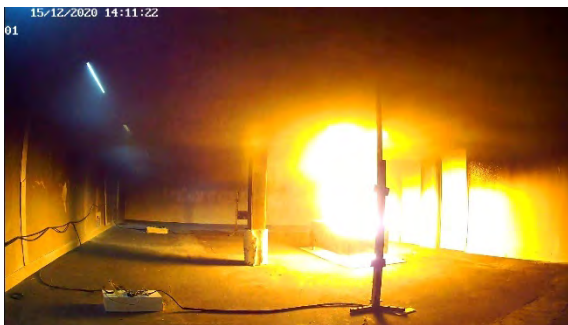
Na 3'22" (activatie 1 e sprinkler)
