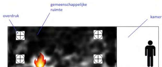
Gemeenschappelijke ruimte (= brandruimte) volledig gevuld met rook: een onmiddellijke evacuatie uit de kamer is niet mogelijk
