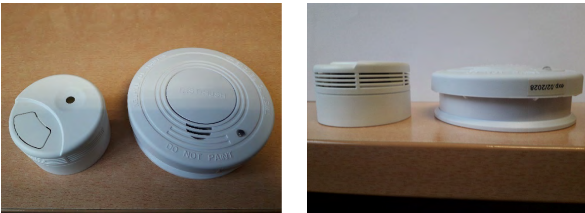
Figuur 12: Optische rookmelders van het type FHB-150 Midi (links op elke foto) en SA-19/1 (rechts op elke foto)
