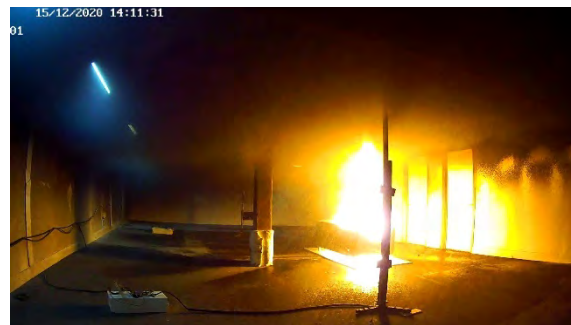
Na 3'31" (activatie 2 e sprinkler)
