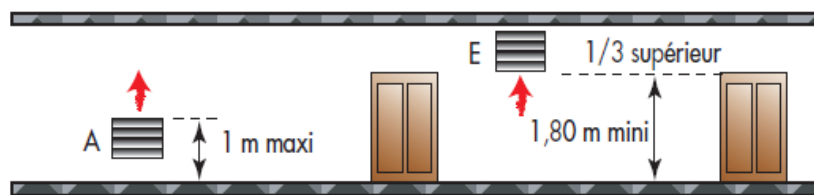
Figuur 8: Locatie van de mechanische pulsie en extractie in een evacuatieweg (verticale doorsnede)
