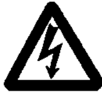
Gevaar voor elektrische spanning
